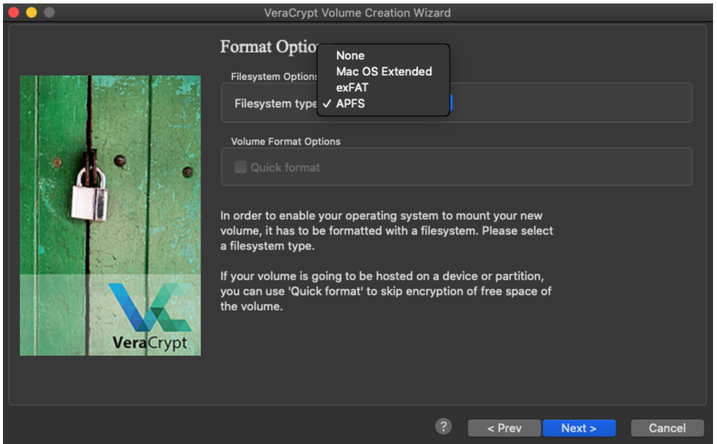
10. Im folgenden Fenster kann bestimmt werden, ob das VeraCrypt Volume NUR für macOS sein soll oder aber auch für Windows (Plattformübergreifend)
